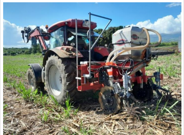
Figure 2 : Semoir à disque trancheur de paille (à utiliser avec du paillis). Photo : eRcane.
