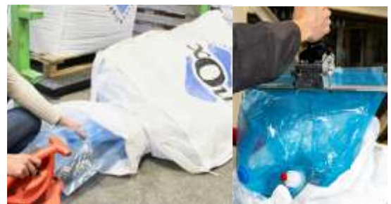
Figure 4 : Sacs hermétiques saturés de CO 2 utilisés pour asphyxier les bruches https://noxstorange.com
